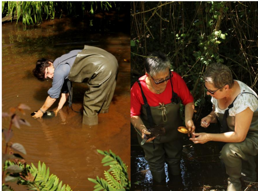
Figure 6. Illustration de la mise en œuvre sur le terrain de l'échantillonnage ponctuel (à gauche) et passif (à droite).
