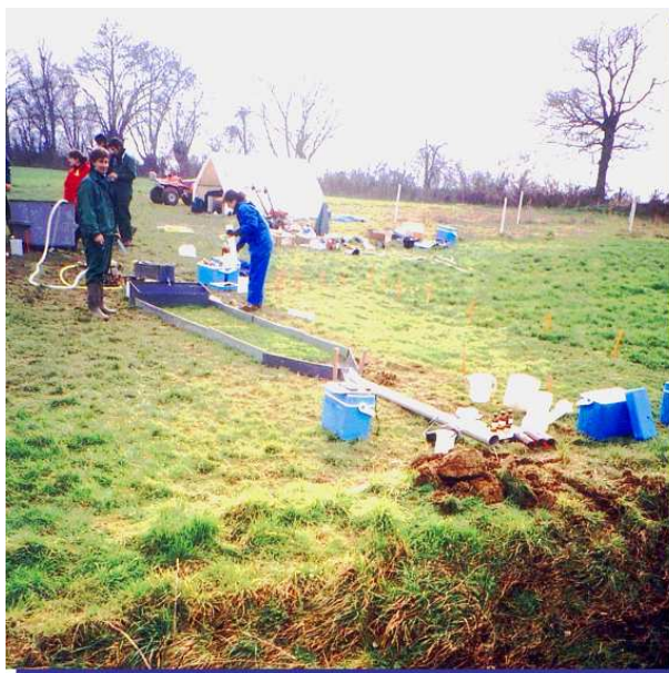
Figure 7 : Dispositif de simulation de ruissellement. Site de la Jaillière (Photo C. Souiller)
