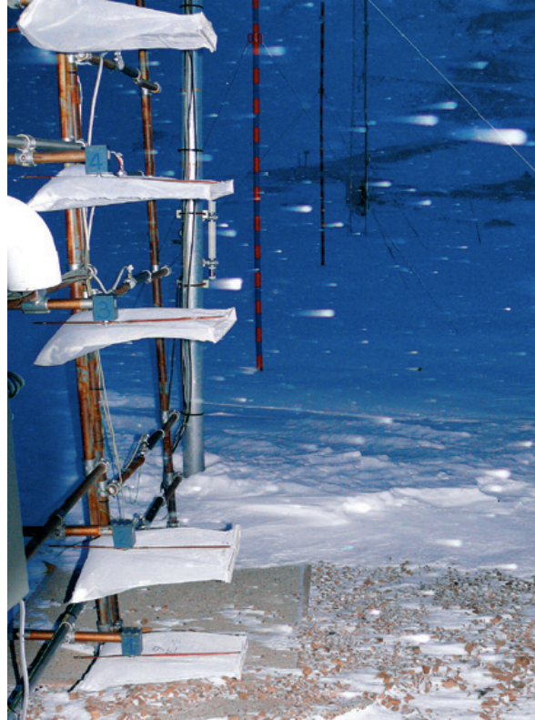
Figure 32 : filet à papillon utilisé dans les Alpes (Naaim-Bouvet et al., 2010)
