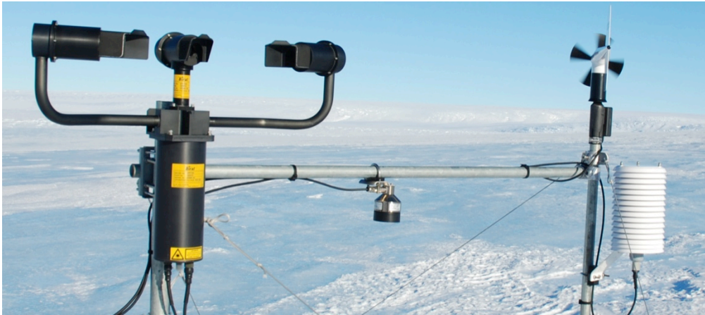
Figure 84 : le disdromètre VPF730 installé à côté de la SMNA D3 en janvier 2010 (crédit : Trouwillez)
