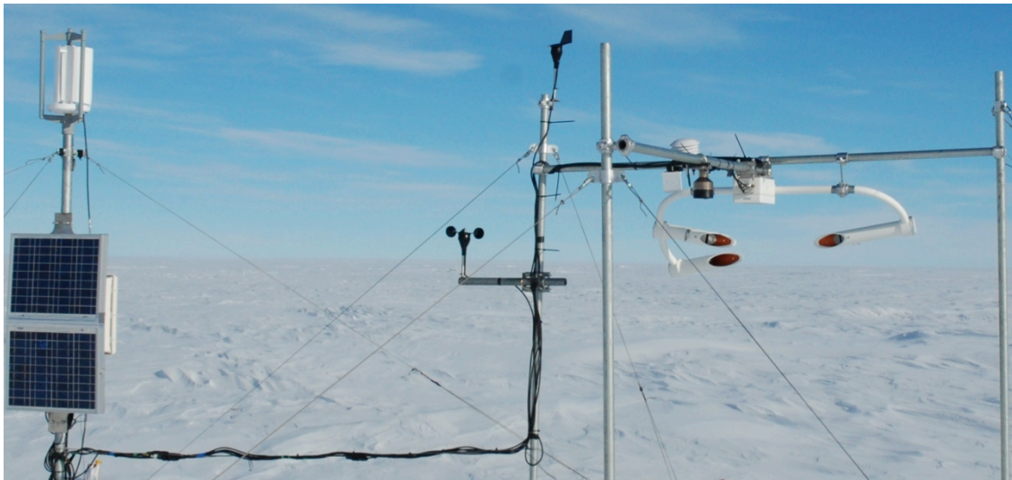
Figure 85 : le disdromètre PWS100 installé au point D47 de telle manière à ce que les plans de mesures soient perpendiculaires par rapport au sol (crédit : Trouwillez)
