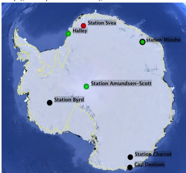
Figure 38 : campagnes de mesures de transport éolien de la neige en Antarctique avant 2009. Les points noirs représentent les campagnes utilisant des capteurs mécaniques, les points verts, des capteurs optiques et les points rouges des capteurs d'impacts. Les campagnes de Port Martin et de Dumont D'Urville ne sont pas représentées, à cette échelle elles se trouvent au même emplacement que celle de Cap Denison (d'après Google Earth)
