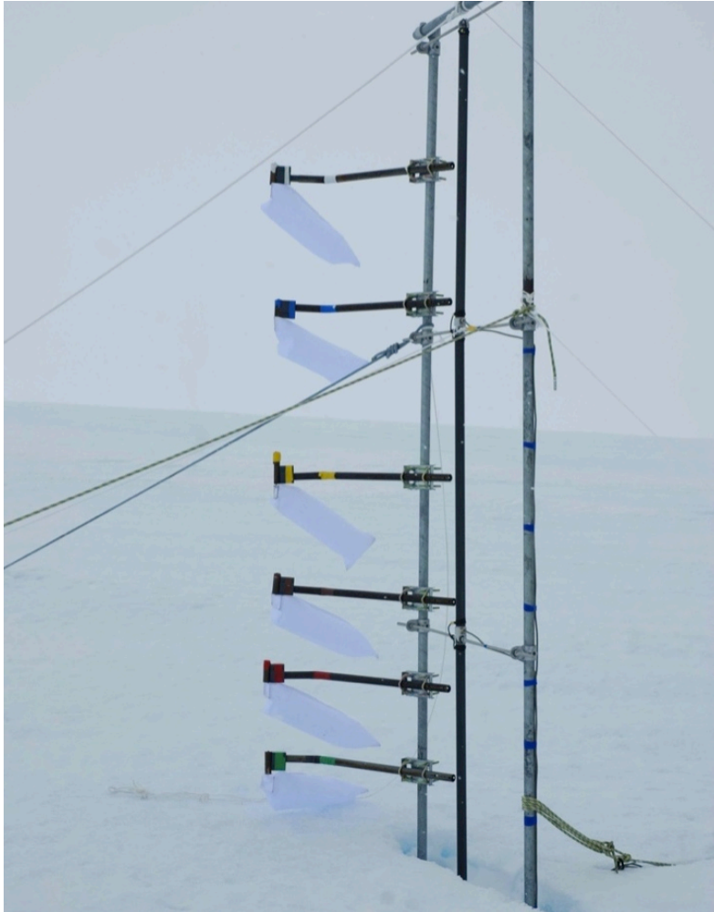
Figure 60 : photographie des 6 niveaux de mesure filet à la SMNA D3 sur le support des FlowCaps première génération (crédit : Trouvilliez)
