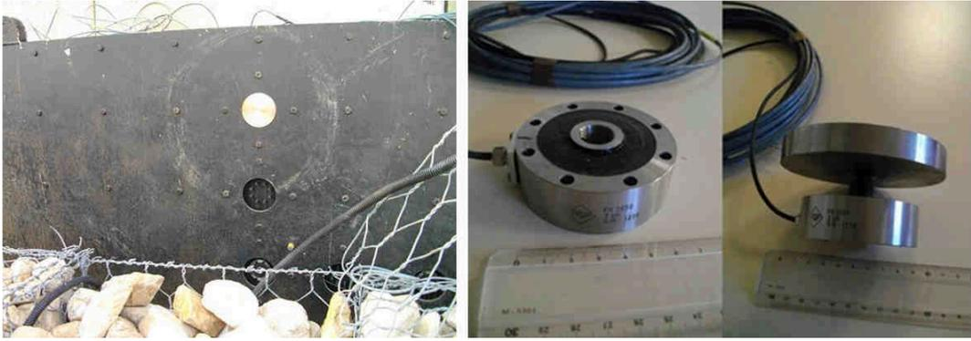
FIGURE 2.16 – Mise en œuvre des capteurs de contrainte à l'échelle réduite.
