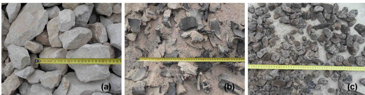
FIGURE 2.3 – Matériaux de remplissage : (a) granulats, (b) mélange de sable et déchetes de pneus, (c) ballast ferroviaire.
