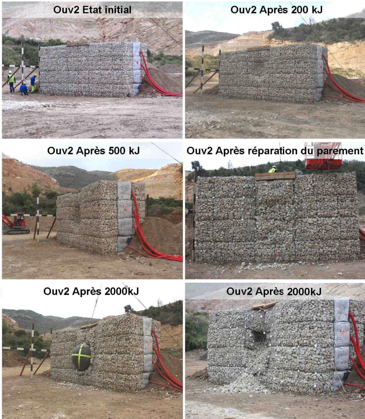
FIGURE 4.33 – Parement impacté de l'ouvrage 2 après chaque essai.
