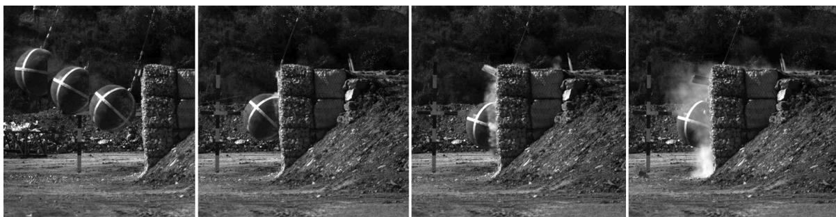
FIGURE 4.2 – Impact à 500 kJ sur l'ouvrage 1.
