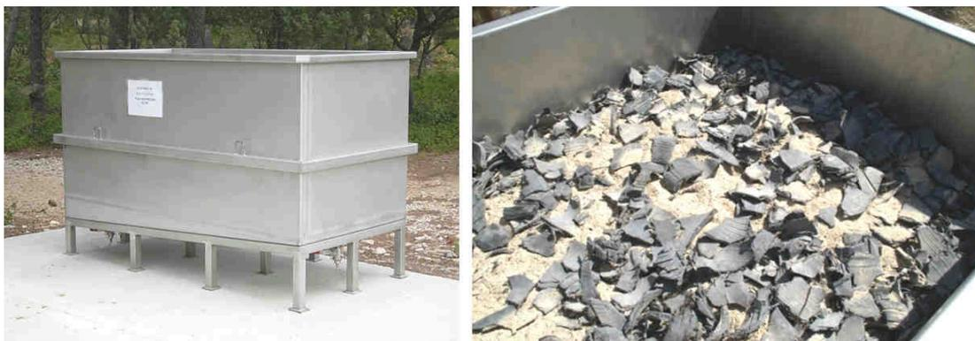
FIGURE 5.13 – L'essai en lysimètre est réalisé en extérieur est a duré 10 mois (clichés INERIS).
