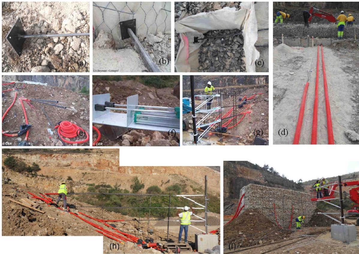
FIGURE 2.24 – Mise en œuvre des capteurs de déplacement pour les expérimentations à échelle réelle sur l'ouvrage dont la partie arrière est un remblai (a) à (h) et sur l'ouvrage de type élancé (i).
