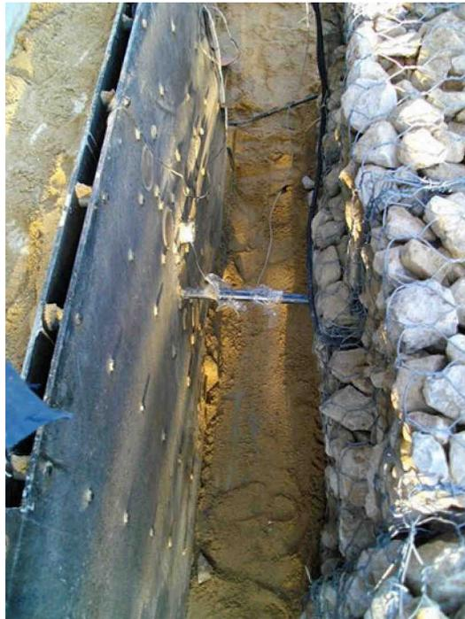
FIGURE 2.22 – Capteur de déplacement à tige installé entre la plaque instrumentée et l'arrière du gabion impacté lors des expérimentations à échelle réduite (vue après démontage).
