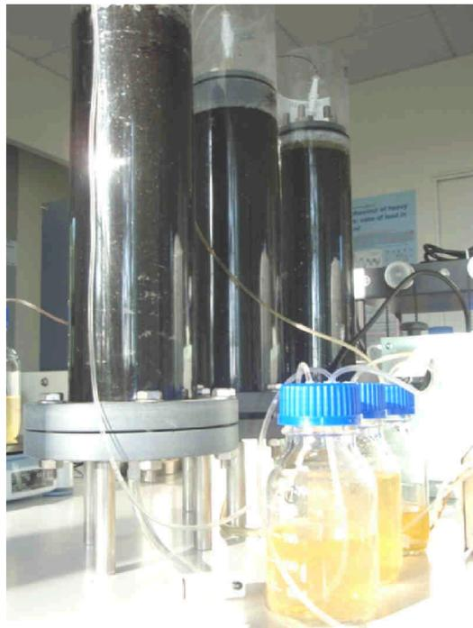
FIGURE 5.12 – L'essai de percolation est réalisé en laboratoire et dure environ un mois (cliché INERIS).
