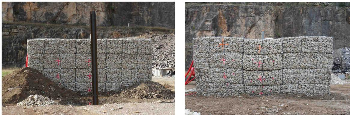
FIGURE 4.34 – Parement aval de l’ouvrage 2 à l’état initial et à l’issue de la série d’impacts.
