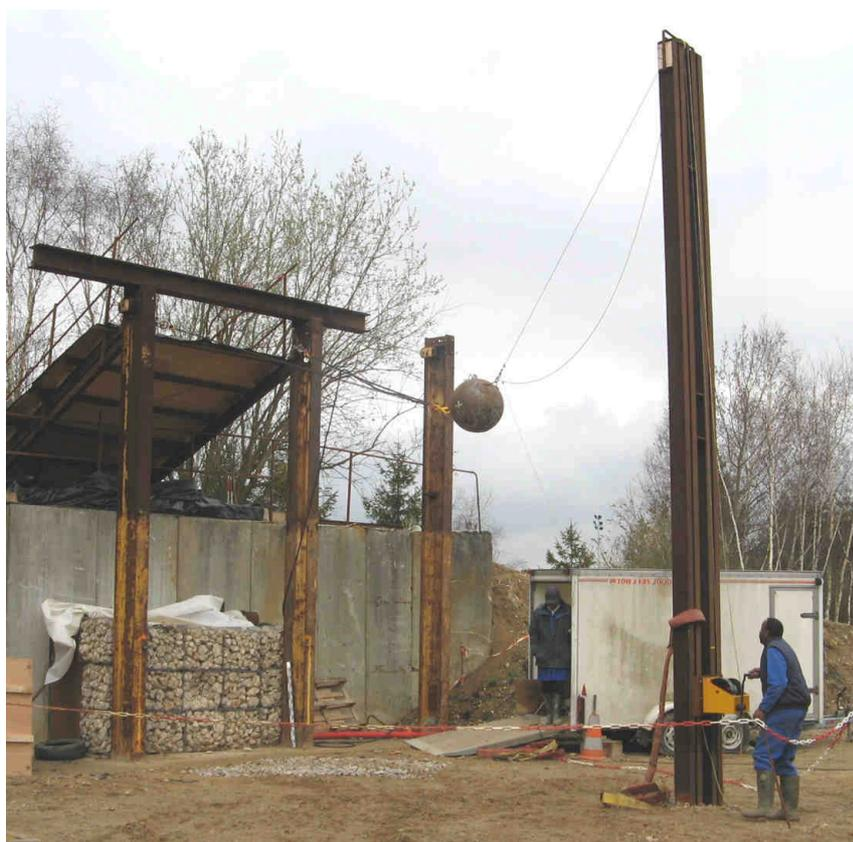
FIGURE 2.5 – Photographie du dispositif expérimental réalisé au CER de Rouen pour les essais à échelle réduite.
