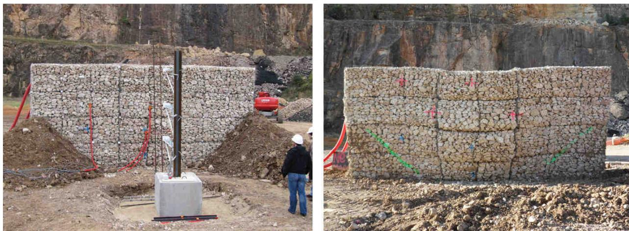
FIGURE 4.37 – Parement aval de l’ouvrage 3 à l’état initial et à l’issue de la série d’impacts.
