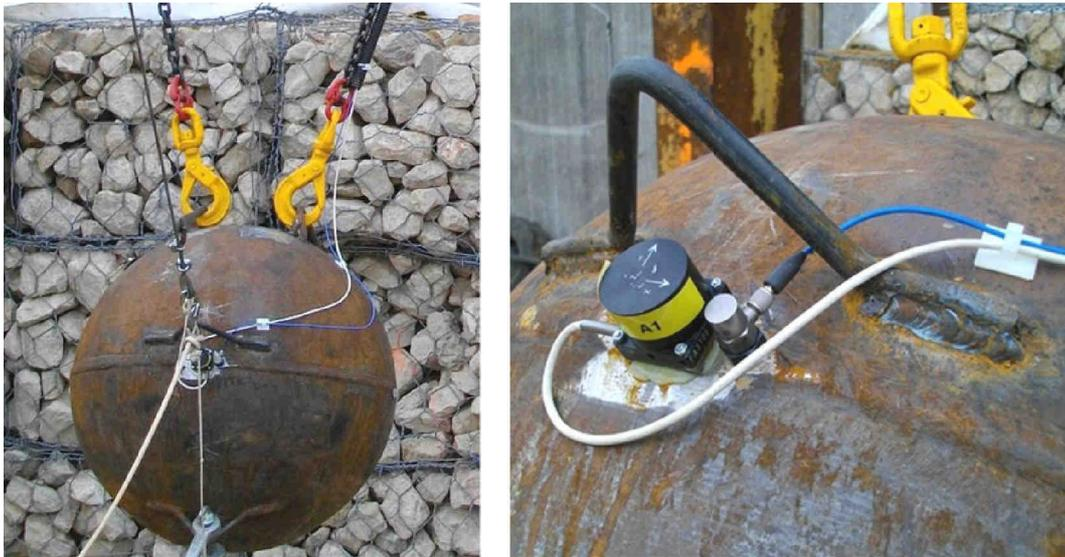
FIGURE 2.10 – Mise en œuvre des accéléromètres de l'impactant pour les expérimentations à échelle réduite.
