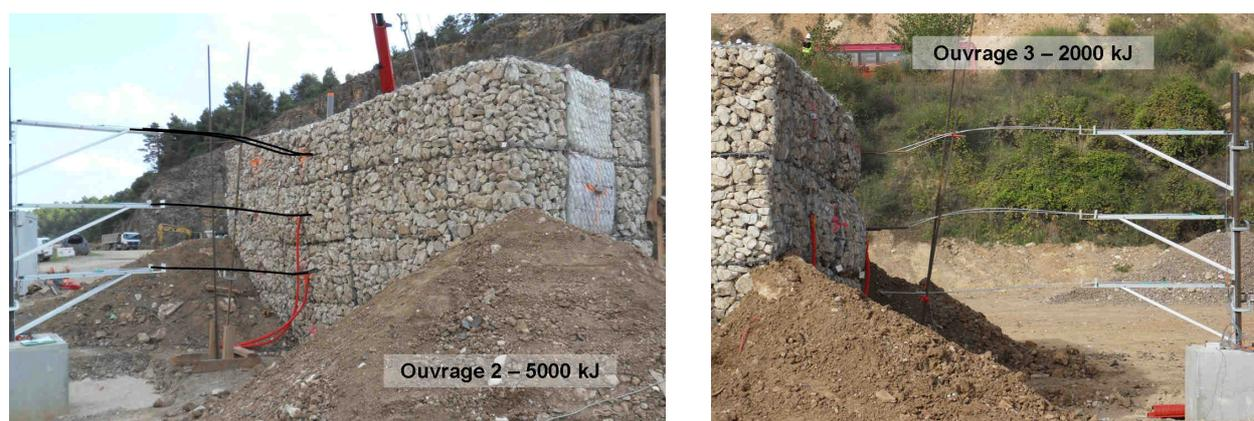
FIGURE 4.41 – Flambage des tiges des capteurs de déplacement.
