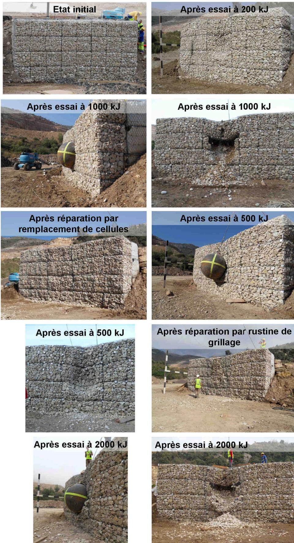
FIGURE 4.3 – Photographies de l'état du parement de l'ouvrage 1 après chaque essai.
