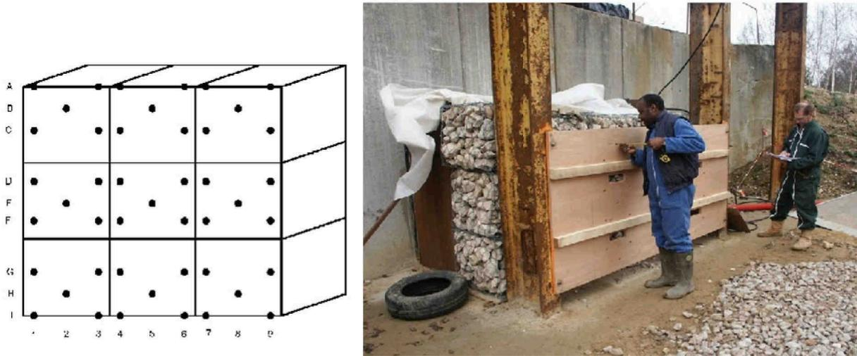
FIGURE 2.12 – Position des points de mesure des déplacements horizontaux et mesure manuelle, expérimentations échelle réduite.
