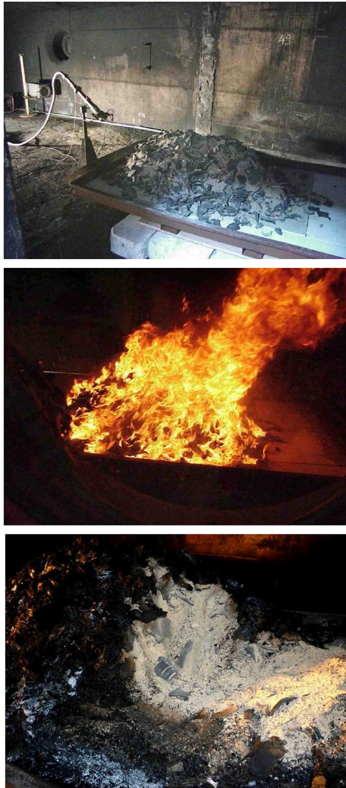
FIGURE 5.14 – Dispositif de test de la capacité du mélange à s’enflammer (en haut), essai d’inflammation en cours (au centre), état du mélange sous la surface après essai (en bas)(clichés INERIS).
