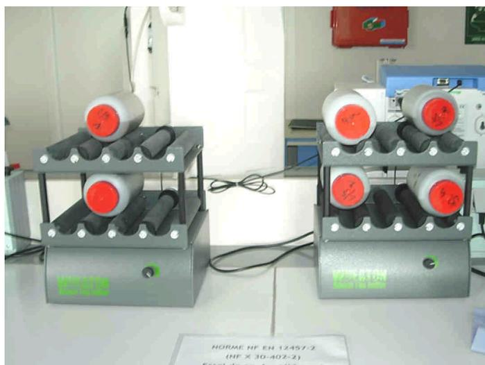
FIGURE 5.11 – L'essai de lixiviation est réalisé en laboratoire et dure 24 heures (cliché INERIS).
