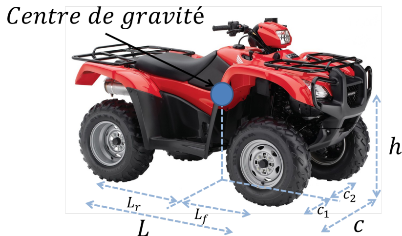
FIGURE 1.16 – Longueurs caractéristiques d'un quad
