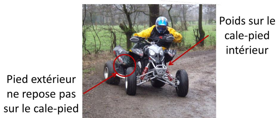
FIGURE 2.6 – Mouvement latéral du pilote lors d'un virage
