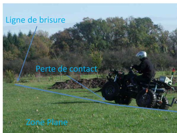
FIGURE 4.17 – Mise en évidence du soulèvement de la roue avant gauche lors du passage de la ligne de brisure
