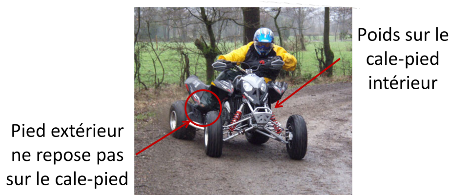
FIGURE 2.6 – Mouvement latéral du pilote lors d'un virage
