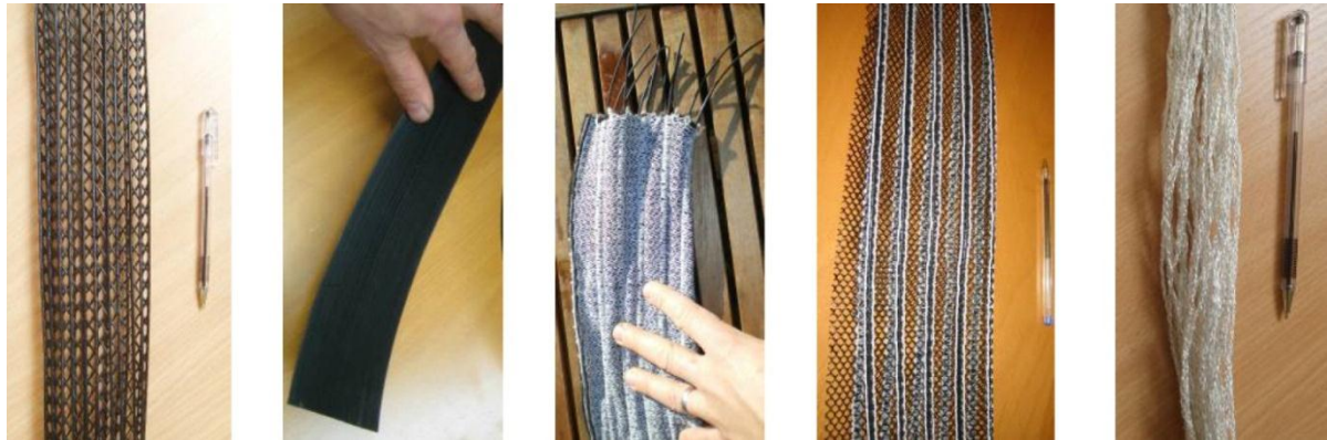
Figure III-9 Exemples d'EKG linéaires (Jones et al., 2008). Selon Jones (CP) aucun de ces matériaux n'a une durabilité suffisante.
