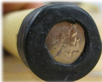
Figure A-3 Extrémité du mini-drain obstruée par un 10 sous.
