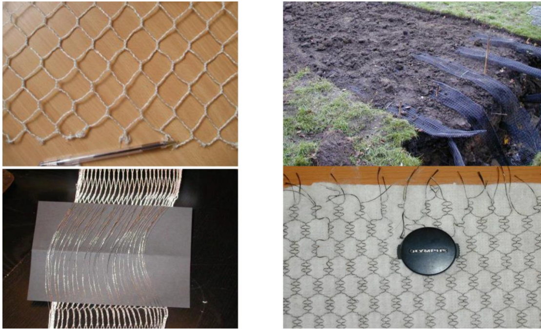
Figure III-11 Exemples d'EKG pseudo-plan (Jones et al., 2008) Tricoté ou tissé comprenant des fils métalliques. Pas d'exemple d'utilisation de ces produits dans la littérature.
