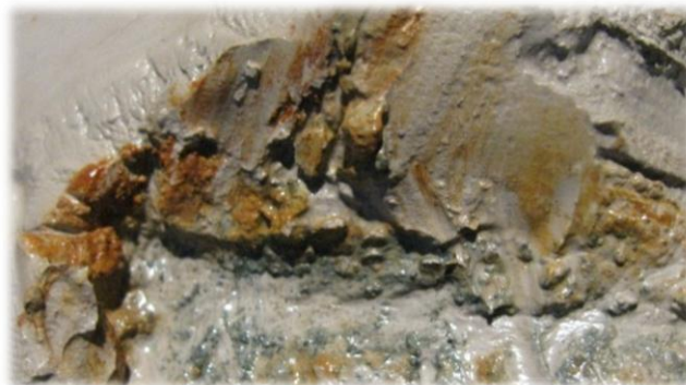
Figure VI-14 Pollution de la boue par les produits de corrosion métallique de la grille en acier chromé : oxyde de fer + oxyde vert, probablement l'oxyde de chrome Cr_2O_3 (pigment du dollar américain).
