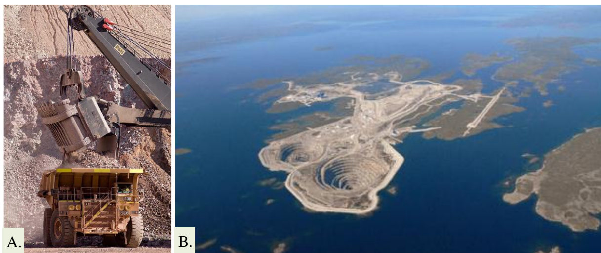
Figure I-5 Gigantisme des mines modernes : A : un tombereau transportant 250 t de minerai, chargé en 2 pelletées. Échelle : la chargeuse mesure 20 m de haut ; B : mine à ciel ouvert de Diavik (milieu arctique, Canada). La teneur en diamant est de 2,9 carats par tonne (soit 580 mg/t). Échelle : La piste d'avion à d. mesure 1600 m (Rio Tinto, 2014).
