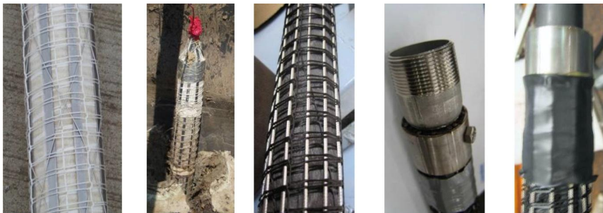
Figure III-10 Exemples d'EKG tubulaires. Notez la grande quantité de métal employée. (Jones et al., 2008).
