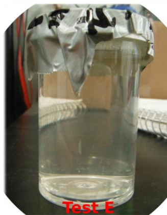
Figure VII-14 Filtrat extrait durant les premières minutes de la filtration (test E)
