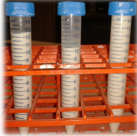
Figure VI-3 Impact des produits d'électrolyse sur une boue de kaolinite 4 h après le mélange. Témoin à gauche, liquide anodique au centre, liquide cathodique à droite.
