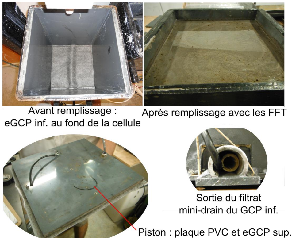
Figure VII-13 Photographies du montage d'un essai d'eGCP avec des FFT.
