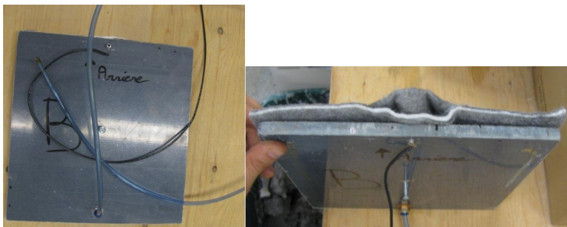
Figure A-12 Vues du piston : Tube de succion et fil d'alimentation en place.
