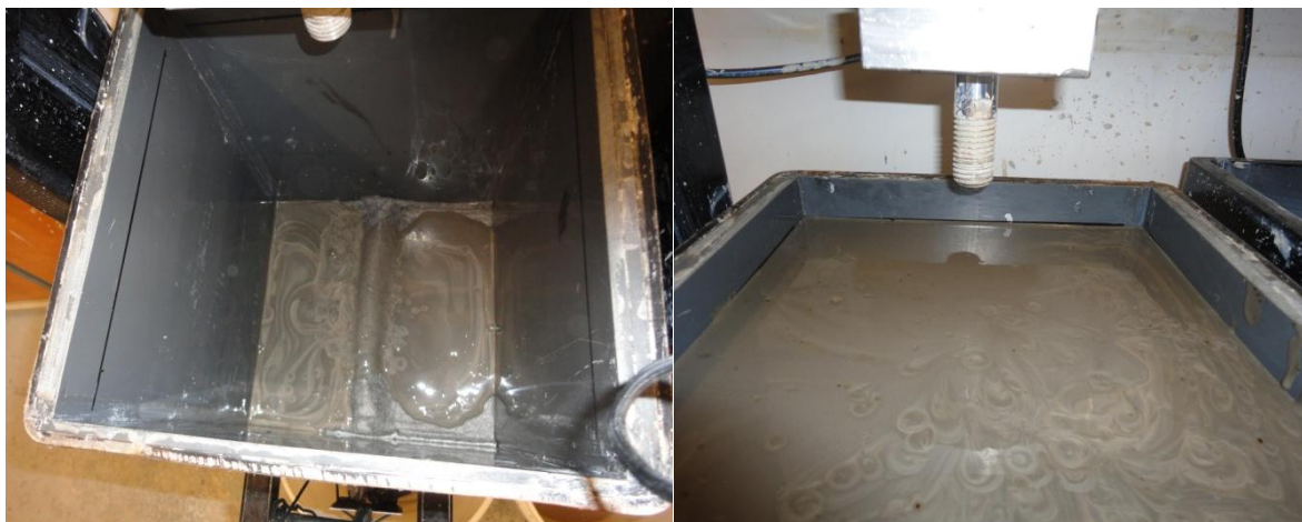
Figure A-13 Début du remplissage : dépôt au centre et répartition de la boue sur l'eGCP. Fin de remplissage au ras du trait arrière.
