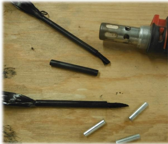
Figure A-5 Fibre de carbone, manchons et gaine thermo-rétractable
