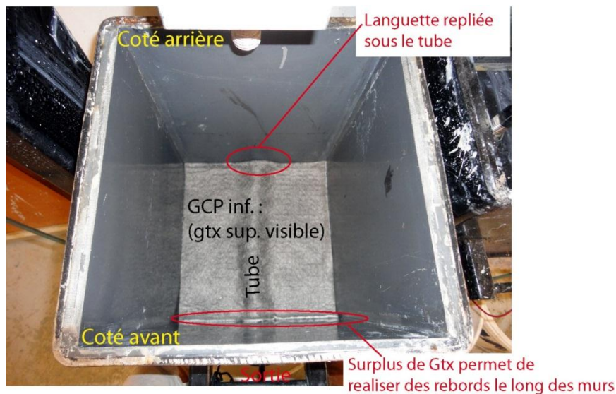
Figure A-8 Vue de l'eGCP inférieur installé dans la cellule
