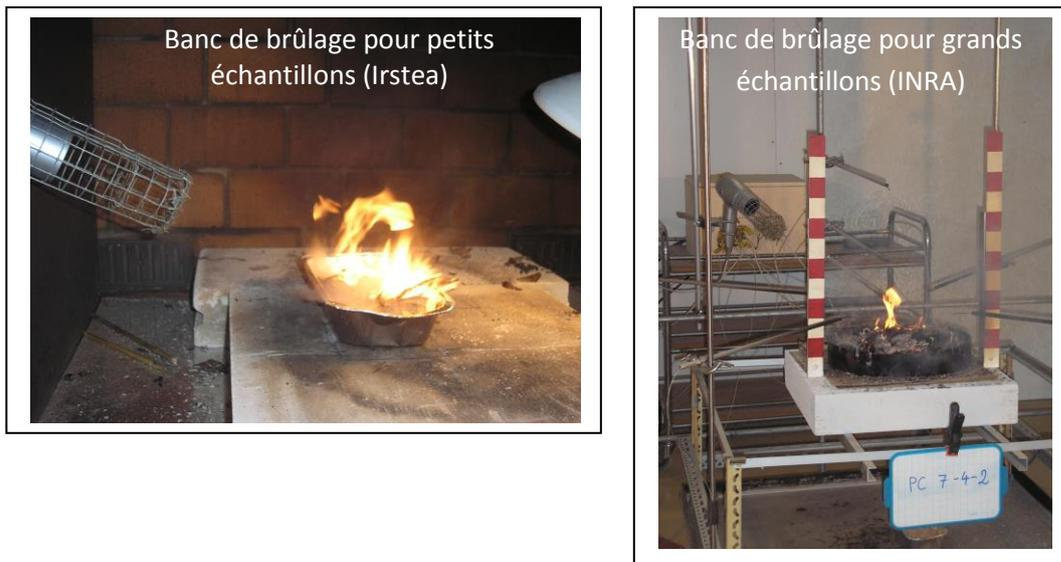
Fig. 14 : Différents dispositifs de brûlage utilisés dans les expériences d'inflammabilité
