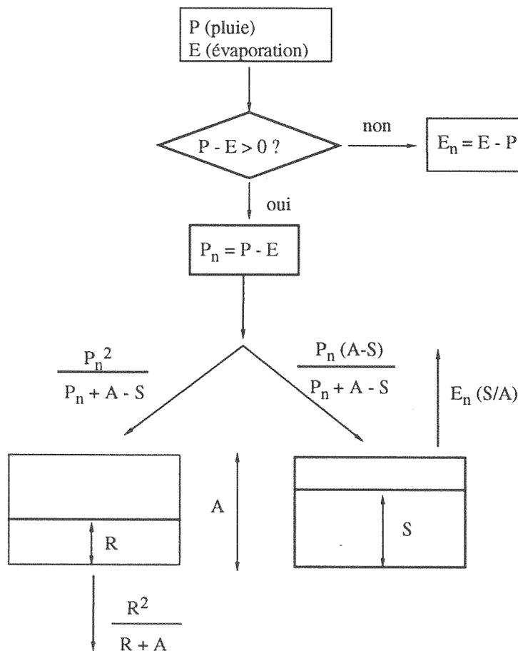
Figure 2-1. Schéma du modèle GR1 (Michel, 1983)
