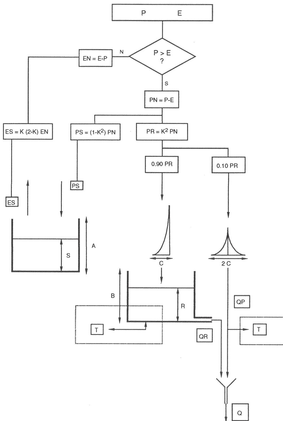
Figure 2-3. Schéma du modèle GR4 (Nascimento et Michel, 1991)
