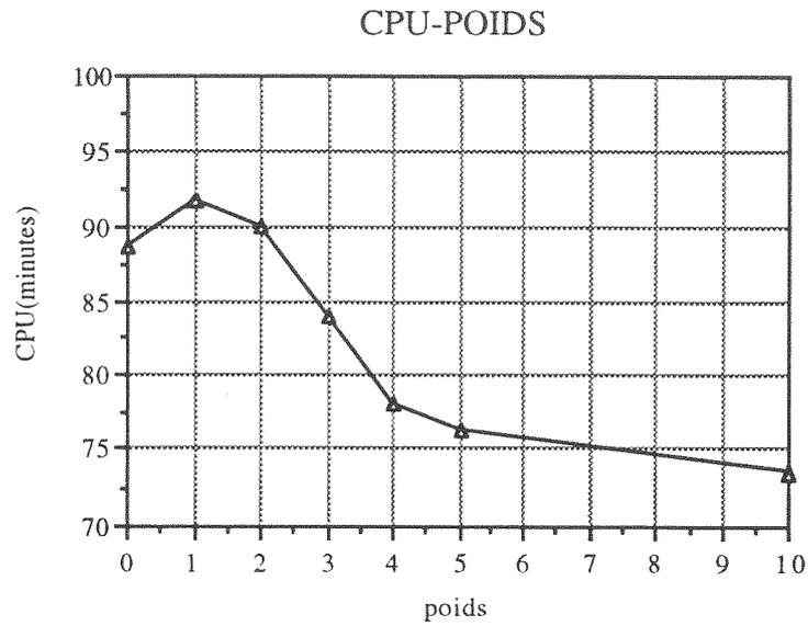
Figure 6-10 Relation entre CPU et les poids.
