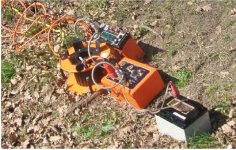
FIGURE 2.13 – Utilisation du Terrameter SAS4000 lors de mesure de polarisation provoquée temporelle in-situ - Centrale d'acquisition relié à un switch multichannel - Batterie d'alimentation et câbles de connexion
