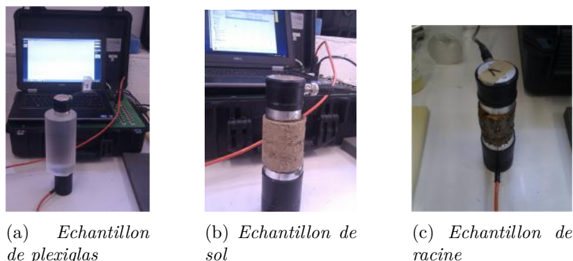
FIGURE 5.5 – Mesure en transmission sur des échantillons de différentes natures
