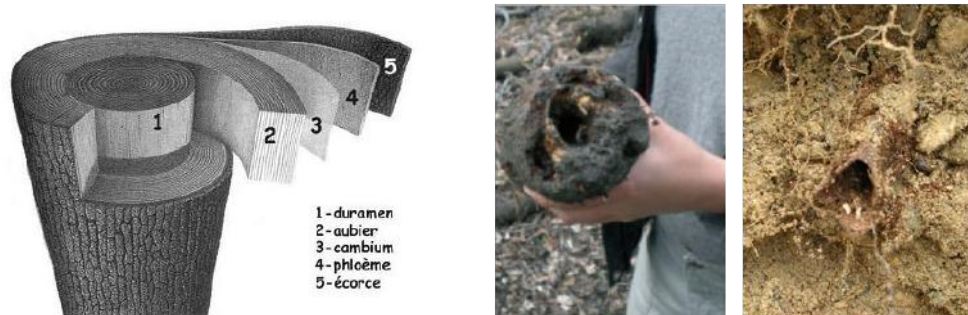
(a) Composition du bois de tronc selon Bary-Lenger and Nebout (1993) (b) Exemples de décomposition racinaire ; le duramen décomposé crée un trou d'érosion (Photographie : C. Zanetti)
