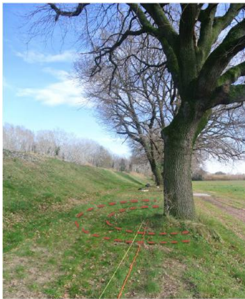
(a) Géométrie d'acquisition des rais de propagation Source-Récepteurs formant un cercle concentrique autour de l'arbre
