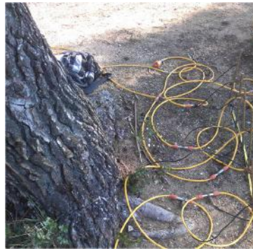
(b) Exemple d'acquisition in-situ et mise en place sur un terrain compact d'électrodes polarisables (en étain)
