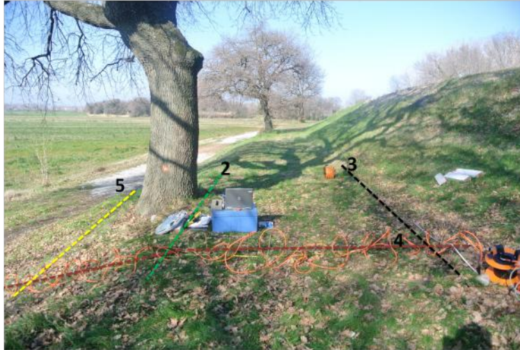
FIGURE 7.7 – Arbre sélectionné, chêne avec un diamètre au collet de 75 cm ; superposition des positionnements des profils à la topographie de la digue (site n°1)
