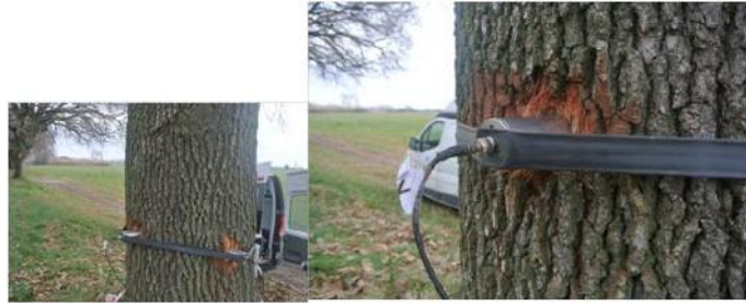
FIGURE 7.10 – Fixation des capteurs sur le tronc préalablement écorcé suivant les quatre axes principaux (Nord-Sud-Est-Ouest)
