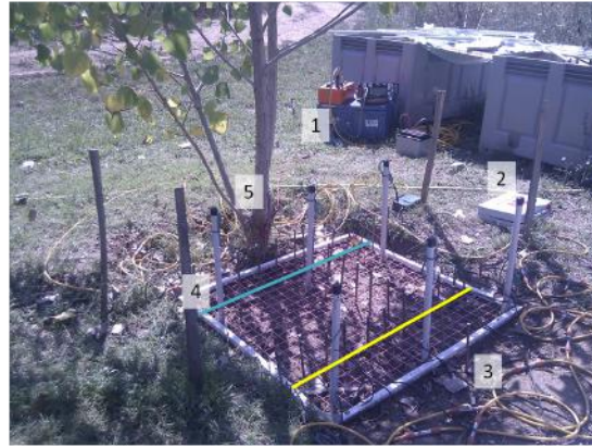
(b) (1) Terrameter SAS 4000; (2) Sonde Watermark pour la mesure de \Theta ; (3) Electrodes en laitons implantées sur 10 cm de profondeur; (4) Maillage carré de dimension 1 m x 1 m; (5) Arbre d'étude, Peuplier de 16 cm de diamètre au collet
