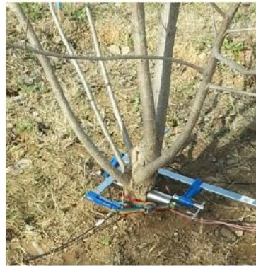
(a) Fixation des transducteurs à l'aide de serre-joint
