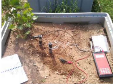
FIGURE 2.11 – Utilisation de l'instrument LIPPMANN en mode sondage ABMN lors de mesure de polarisation provoquée spectrale in-situ ; électrodes d'injection métallique, électrodes de mesures de potentiel imparlarisables de type Petiaut
