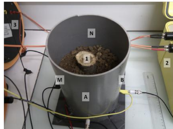
(b) Exemple de mesure PPS avec le SIPFUCHS (2) montrant la géométrie des électrodes d'injection A et B, de mesure de potentiel M et N; (point milieu = câble jaune) et (1) de la position centrale de l'échantillon racinaire
