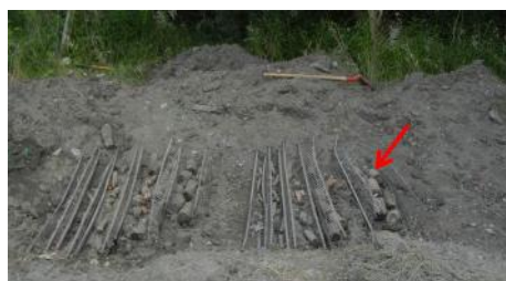
(b) Extraction des échantillons du dispositif en Isère après 6 ans de décomposition (Photo G.Bambara)
