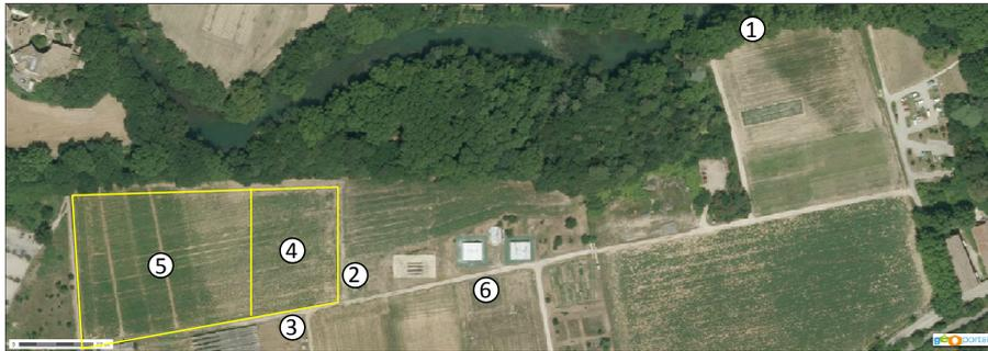
FIGURE 2.2.1 – Dispositif expérimental de la station de Lavalette : (1) la station de pompage à l'amont du réseau, (2) et (3) les bornes d'alimentation hydrique, (4) la zone irriguée par goutte-à-goutte enterré, (5) la zone irriguée par aspersion (par canon enrouleur ou par couverture intégrale) ou non irriguée, et (6) la station météorologique du site.
