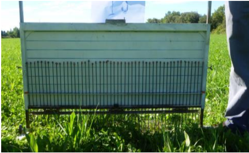
Figure 4. Profilomètre à aiguilles pour la mesure de la rugosité.
