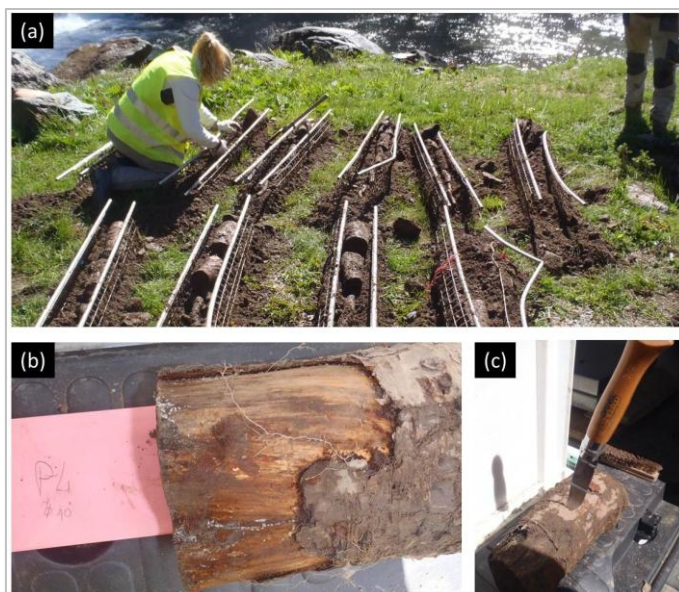
Figure 33. Déterrage du dispositif de Castérino après 4 ans de décomposition (a) nettoyage de chaque échantillon avant d'effectuer les analyses qualitatives (b) évaluation visuelle et tactile de chaque échantillon à l'aide des différentes classes de décomposition (Sandström et al., 2007; Tobin et al., 2007)(c) évaluation de la résistance à la pénétration de la lame de couteau (Renvall, 1995) (Photo : Bambara G., 2013)
