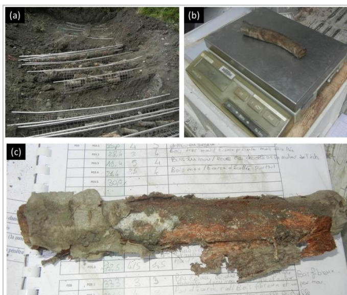
Figure 34. Déterrage du dispositif expérimental de l'Isère après 6 ans de décomposition (a) déterrage des paniers à la pelle mécanique (b) pesée des échantillons frais (c) évaluation visuelle et tactile de chaque échantillon à l'aide des différentes classes de décomposition (Sandström et al., 2007; Tobin et al., 2007) et description de chaque échantillons (photo : Bambara G., 2014)
