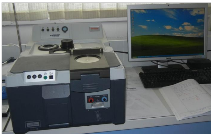
Figure 38. Spectromètre Antaris II FT-NIR, Thermo-Nicolet du laboratoire LISA-METICA, Université Aix-Marseille (photo : Bambara G., 2013)
