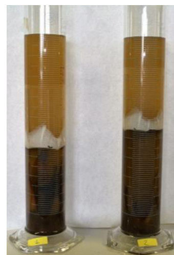
Figure 39 : Eprouvette graduée utilisée pour la détermination de la masse volumique réelle du bois broyé.
