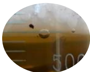
Figure 88 : Bulles d'air à éviter avant ajustement final du niveau d'eau. ©ABG.
