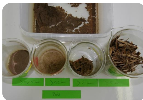
Figure 40 : 5 fractions obtenues après le fractionnement granulométrique d'un échantillon de bois. © Alexandre Barrier-Guillot
