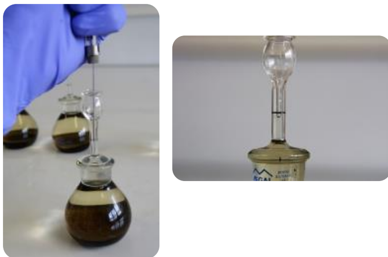
Figure 82 : A gauche, ajustement d'un pycnomètre avec une aiguille médicale. A droite, niveau d'éthanol incorrect car en dessous du trait de repère d'un pycnomètre. ©ABG
