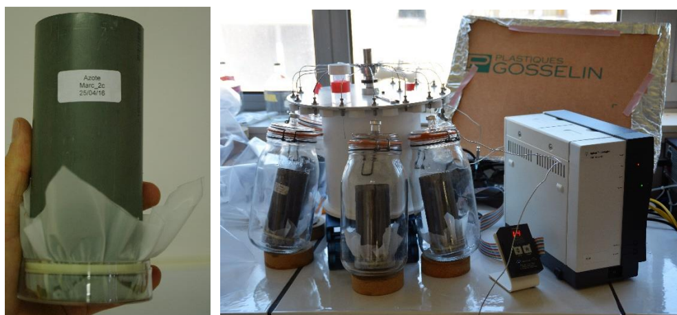
Figure 41 : Photographie, à gauche : un tube PVC contenant un (minéralisation du carbone) ou deux (minéralisation de l'azote) échantillon(s). A droite : photographie du micro-GC et d'échantillon en cours de mesure pour leur teneur CO 2 . ©Alexandre Barrier-Guillot et Baptiste Gard.
