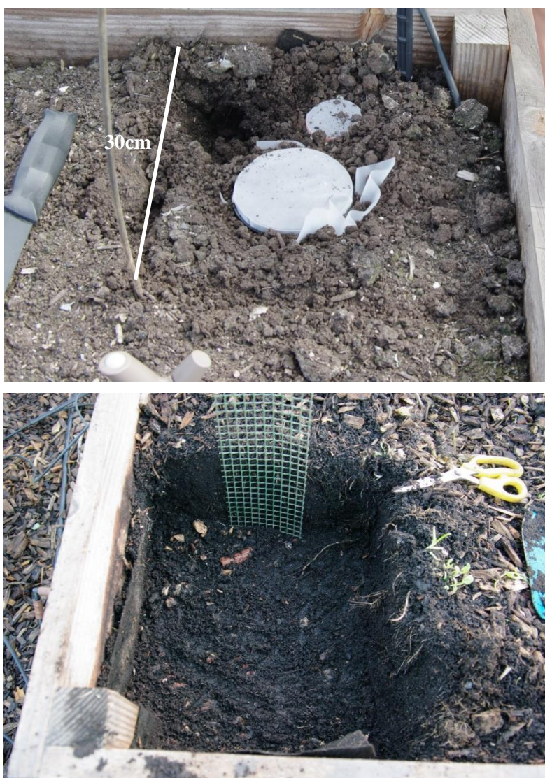
Figure 36 : A gauche, photographie sur un Technosol à 6 mois de deux cylindres de pF enfoncés dans l'horizon supérieur du Technosol. A gauche : photographie d'une grille (maille - 1cm) servant au profil racinaire ici pour l'horizon supérieur. Les deux photographies ont été prises sur les Technosols du dispositif n°3. ©Alexandre Barrier-Guilot et Baptiste Gard.
