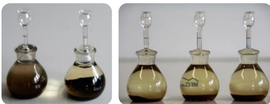
Figure 81 : Décantation incomplète dans le pycnomètre de gauche. A droite, la décantation est satisfaisante. ©ABG.
