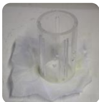
Figure 83 : Bouchon composé d'un tube PVC et de toiles de lyoph. ©ABG
