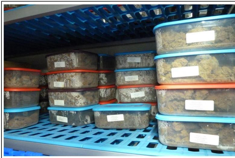
**Figure II- 9.** Conservation des blocs de sols dans une chambre froide (4°C)
