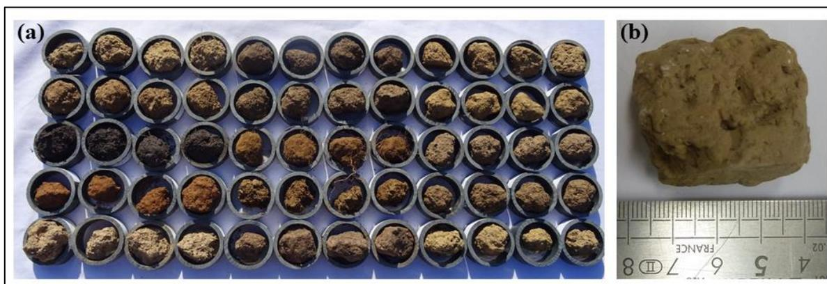
**Figure II- 10.** Exemple d'échantillons de sols utilisés : (a) sélection de sols de l'horizon A de la base de données sols de Bretagne et (b) motte de sol de taille centimétrique.
