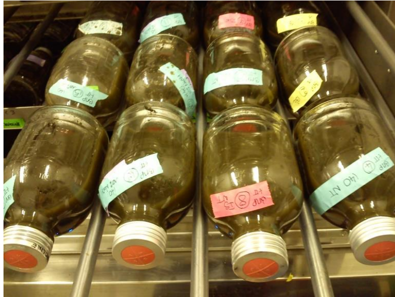
Figure 2-4: fioles de test BMP sur un tiroir de la table agitante placée dans une pièce thermostatée à 35°C
