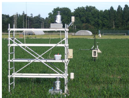
Figure 15 : dispositif de mesure des flux : échafaudage de 2 mètres de haut avec des appareils pour mesurer des températures, la vitesse du vent, le flux de chaleur sensible, et capturer les bactéries en suspension dans l'air.
