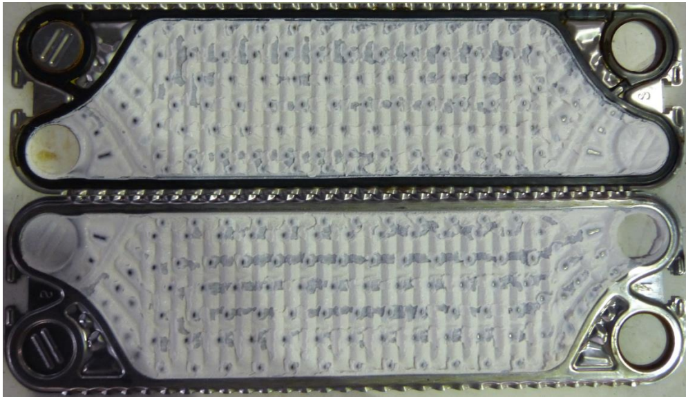
Figure 5. Photo de plaques d'un échangeur de chaleur encrassé.
