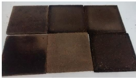
Figure 34 : Les panneaux de fibres fabriqués à partir des tourteaux de fenouil
