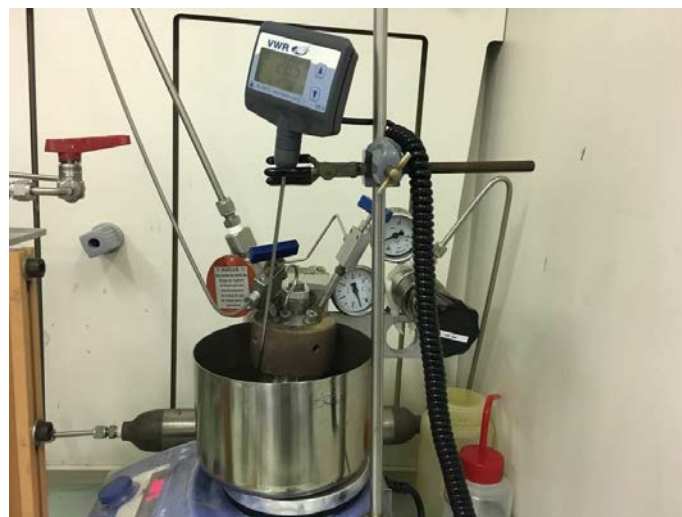
Figure 58 : Schéma général du réacteur utilisé dans l'hydrogénation de l'huile d'amarante
