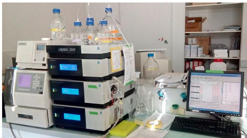
Figure 19 : Photo de la chromatographie liquide haute performance
