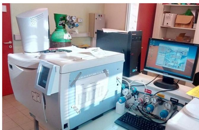
Figure 18 : Photo du chromatographe en phase gazeuse
