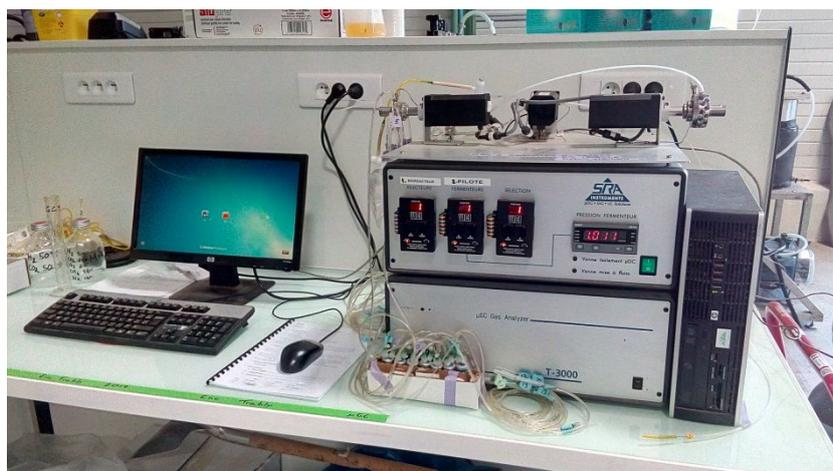
Figure 20 : Photo du micro-chromatographe en phase gazeuse multiplexé
