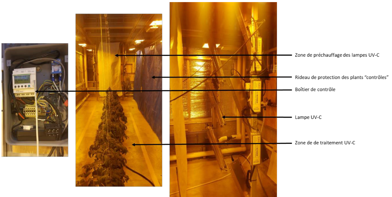
Figure 51 : Traitements UV-C des plants de tomate sous serre. Un portique contenant 6 lampes UV-C se déplace automatiquement le long des plants de tomate pour délivrer une dose UV-C choisie de 0,20 kJ/m 2 .
