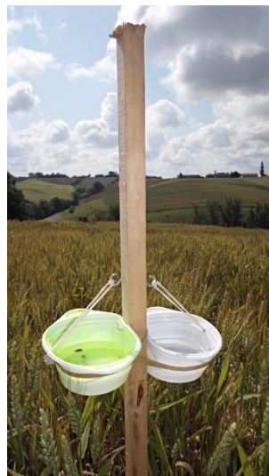
Figure 13 Photographie d'un site d'échantillonnage, constitué d'un poteau portant deux coupelles colorées, dont la hauteur était ajustée à la hauteur du couvert de la culture (photo : Léa Frontero).
