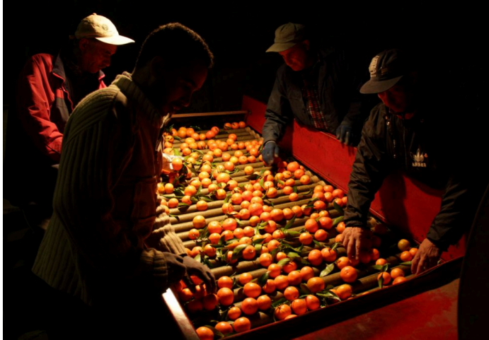
Figure 90. Sur la table de tri, les fruits défilent sur des rouleaux devant 4 ouvriers, selon un rythme déterminé par le chef de station. Le rôle des stations est de convertir les fruits hétérogènes issus des parcelles en lots homogènes en termes de calibre et qualité visuelle. © R. Belmin.
