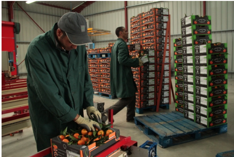
Figure 96. En sortie de chaîne, un premier ouvrier répartit les fruits dans la caisse afin d'éviter l'écrasement lors de leur empilement. Un second place une caisse sur une palette d'expédition. © R. Belmin.
