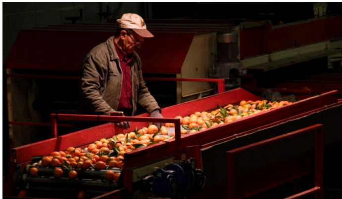
Figure 92. Un ouvrier est placé en amont de la table de tri pour réaliser un premier tri de dégrossissage, car la récolte d'un apporteur présentait beaucoup de fruits non commercialisables. Les stations de conditionnement sont des nœuds dans la gestion de la qualité, où les problèmes de qualité qui se sont construits au verger peuvent être corrigés. © R. Belmin.
