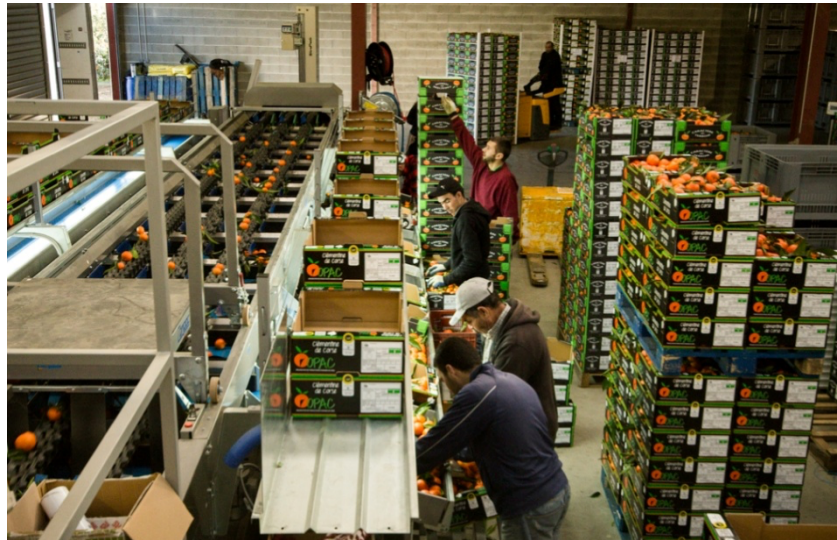
Figure 94. En sortie chaîne de conditionnement, les ouvriers placent les fruits dans des caisses, et ajustent le tri et le calibre manuellement. La qualité des lots expédiés dépend de la précision avec laquelle les fruits sont regroupés en catégories homogènes de qualité visuelle et de calibre. © R. Belmin.
