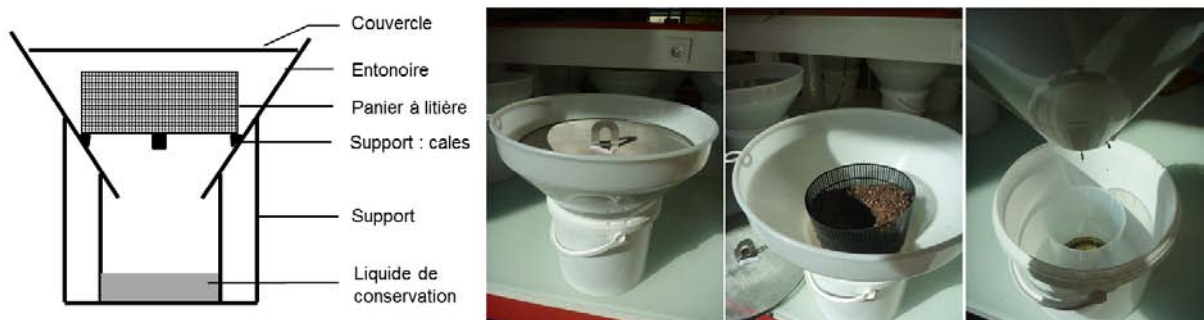
FIGURE 5.2 – Photographie et représentation d'un Berlese, utilisé pour l'échantillonnage et la capture de coléoptères saproxyliques aptères
