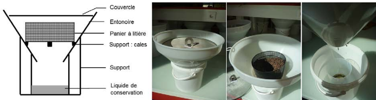
FIGURE 5.2 – Photographie et représentation d'un Berlese, utilisé pour l'échantillonnage et la capture de coléoptères saproxyliques aptères
