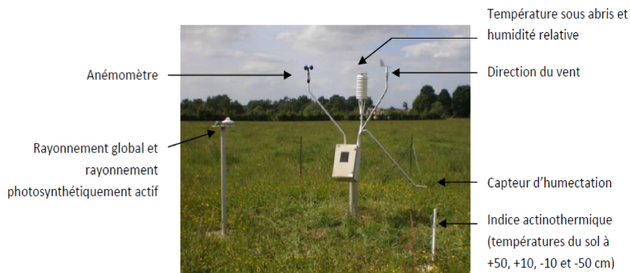
FIGURE 2.8 – Désignation des instruments de mesure à la station météorologique au lieu-dit le Touлло (thèse Alice Aubert)
