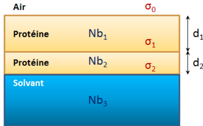
FIGURE 2.16 – Schéma du modèle « en boîtes » utilisé pour l'ajustement aux données expérimentales de réflectivité de neutrons sur des interfaces air/eau de protéines. Nb_i et d_i représentent la densité de longueur de diffusion et l'épaisseur des couches, respectivement, et \sigma_j la rugosité des interfaces.
