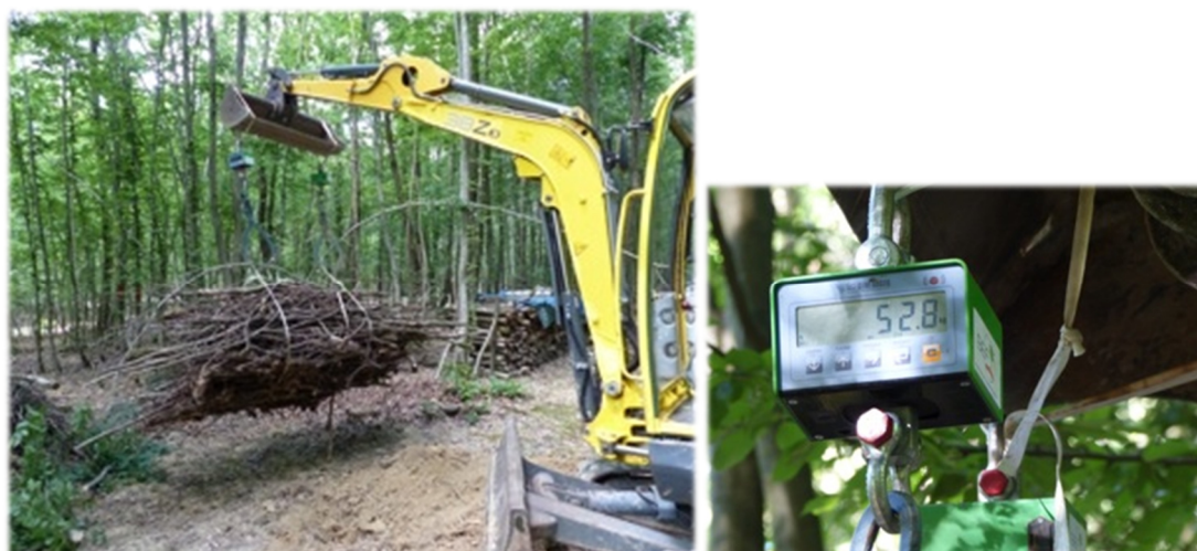
Figure IV.3 : Pesée des fagots in situ à l'aide d'une balance (à droite) suspendues à un bras de pelleteuse (B.Zeller)
