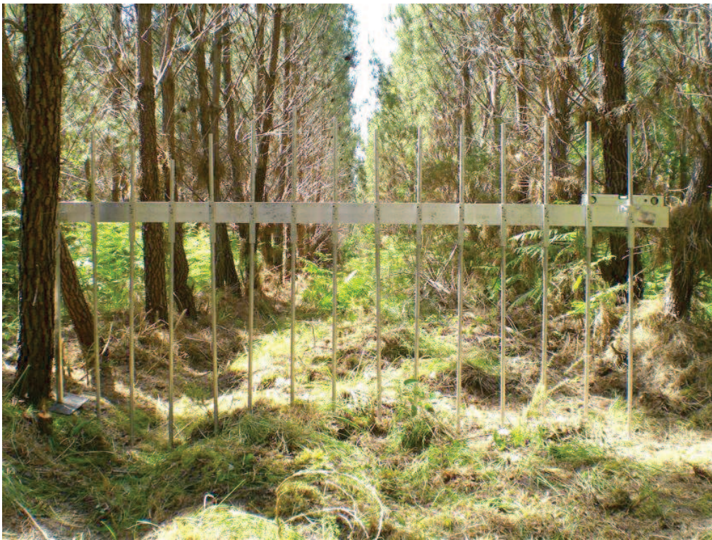
Fig. 1 Peigne à microtopographie utilisé sur une interligne de la parcelle labourée en bande de Nezer perpendiculairement à la ligne de plantation. Le peigne est positionné au pied de l'arbre et est constitué d'un tube fixe et de 14 tubes gradués et coulissants espacés de 20 cm. Une mise à niveau de la règle horizontale est faite avec le dernier tube qui est équipé d'un dispositif de serrage.
