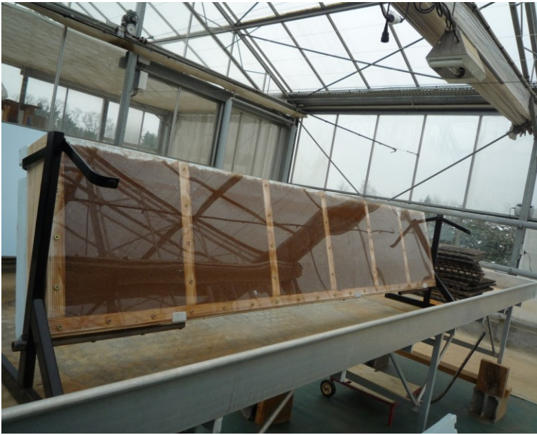
Figure 2.7 : Photographie d'un des rhizotron utilisé dans la première expérience avant transplantation des plantules. Le rhizotron est composé de 6 compartiments et est incliné d'un angle de 25°. La plaque en PVC transparent permet d'observer le développement racinaire in situ.
