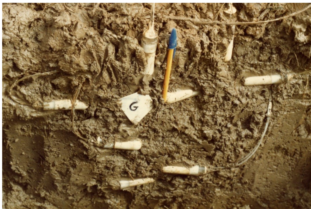
Figure 8. Dispositif de préleveurs encadrant la position d'enfouissement du supergranule d'urée (symbolisée par la lettre G) (photo R. Gaudin)
