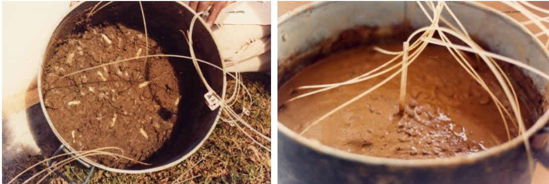
Figure 10. Dispositif pour l'étude de la diffusion de l'azote ammoniacal en laboratoire (vue avant et après remise en place du sol au-dessus du plan de mesure) (photos R. Gaudin)
