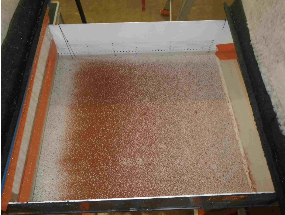
FIGURE 4.16 – Dépôt de sédiments au fond du banc pour l'expérience P_{175}^13 .
