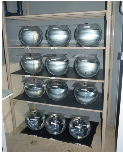
Figure 20 : Installation expérimentale utilisée pour la contamination des civelles.
