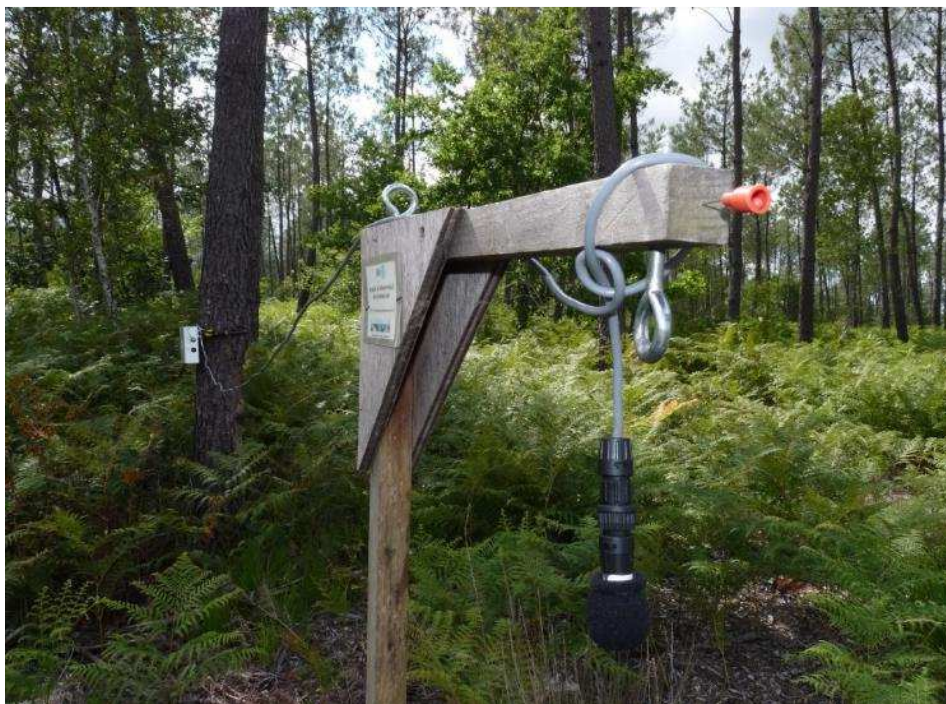
Dispositif d'échantillonnage avec micro et diffuseur de phéromone.
