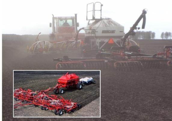
Figure 1.8. Les ensembles machine-tracteur avec trois éléments trainés : les rouleaux de nivelage (Bourgault) ; en bas : la tonne à azote liquide (Morris).
