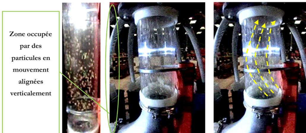
Figure 4.14. Sortie du coude à différents instants : la zone contre la paroi intérieure du coude (à gauche de l'image) reste non-remplie. Après le rebond les particules se dirigent dans le sens opposé de la paroi extérieure.
