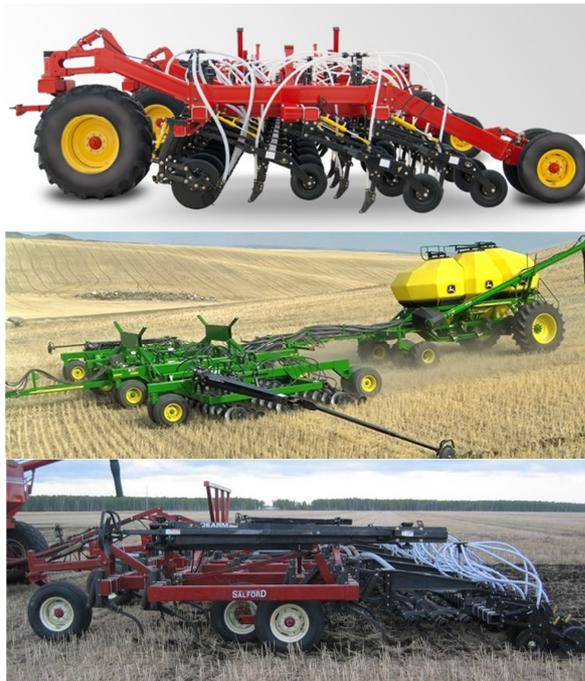
Figure 1.5. Les barres de semis des semoirs pneumatiques. De haut en bas : à dents, à disques, hybrides (Source : Bourgault, John Deere, Salford, respectivement).
