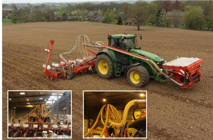
Figure 3.4. Semoir monograine Kuhn Maxima 2 TI 8rangs combiné avec la trémie frontale Kuhn TF-1500.
