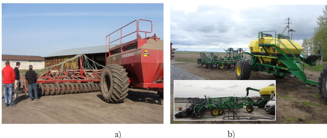
Figure 1.3. a - Semoir avec distribution centralisée « Horsch-Agro-Soyuz ». b – Semoir avec distribution multicanale « John Deere ».
