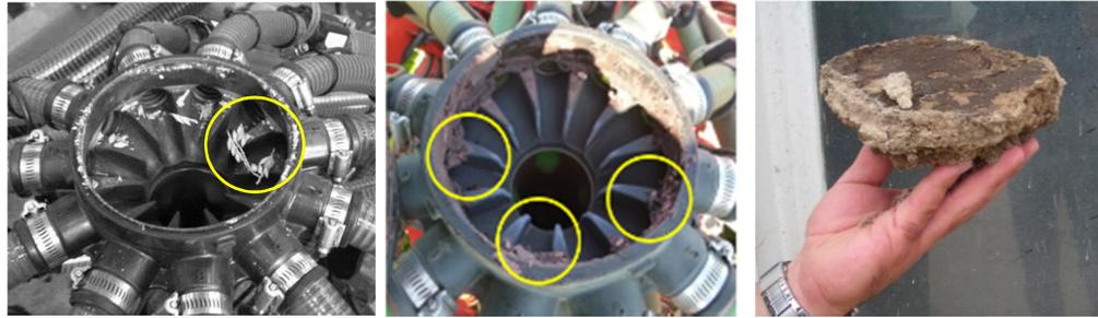
Figure 4.7. A gauche : épi d'orge en travers d'une sortie de répartiteur John Deere. Au centre : agglomération d'engrais en travers d'une sortie de répartiteur John Deere.
