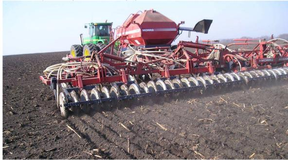
Figure 1.7. Sol nivelé après le passage avec la barre de semis derrière. Les traces des roues de la trémie roulante ne sont pas perceptibles. Morris Maxime II. Ukraine, 2007.
