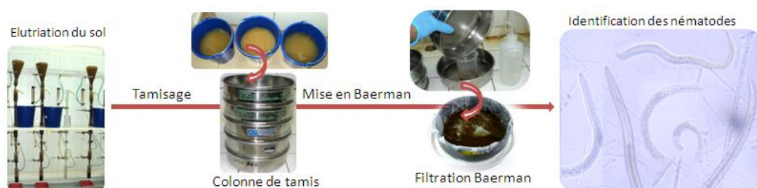
Figure 10 : Les étapes d'extraction de nématodes du sol par élutriation et filtration Baerman
