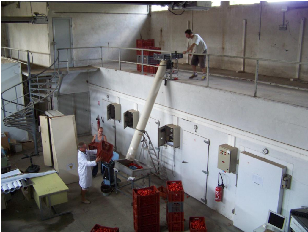
Figure 41 : Dispositif permettant d'abimer artificiellement les tomates
