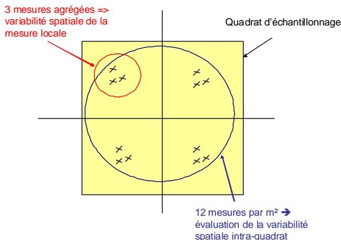
Figure 3-30 : Schéma du protocole de mesure de  $\theta$  grâce aux sondes Theta Probe au sein de chaque quadrat (1m<sup>2</sup>)
