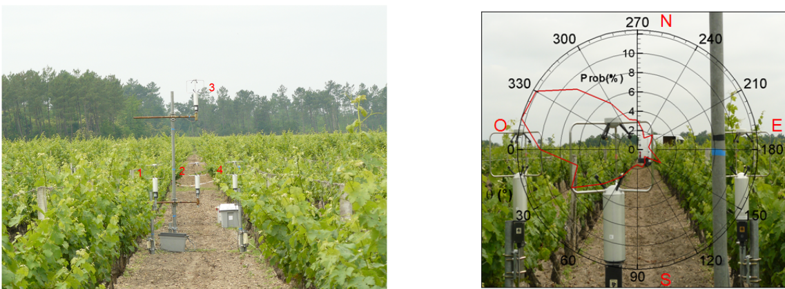
Figure III.3 – (a) Vue de la parcelle de vigne expérimentée avec le montage du système d'anémomètres soniques. (b) Distribution de la direction du vent durant l'expérience.
