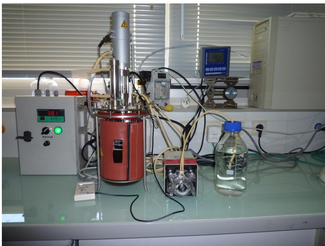
Figure II-1 : Photographie du réacteur continu de production d'hydrogène par voie fermentaire.
