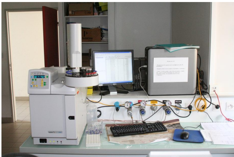
Figure II-7 : Chromatographe Varian GC 3900 et son passeur automatique.
