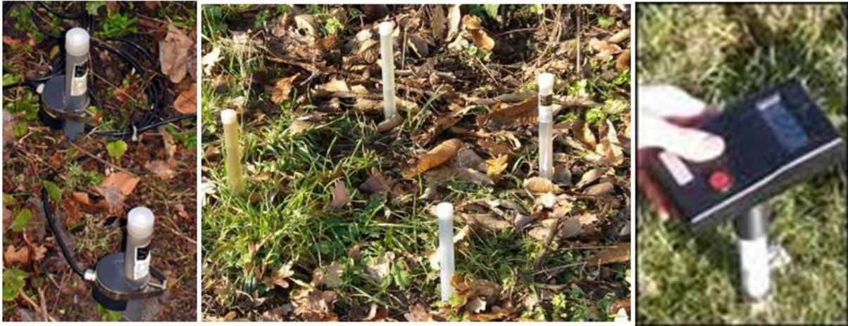
Figure 2.14 – Photographie de lots de tensiomètres avec (gauche) ou sans (milieu) capteurs automatiques, et mesure avec un tensimètre (droite).
