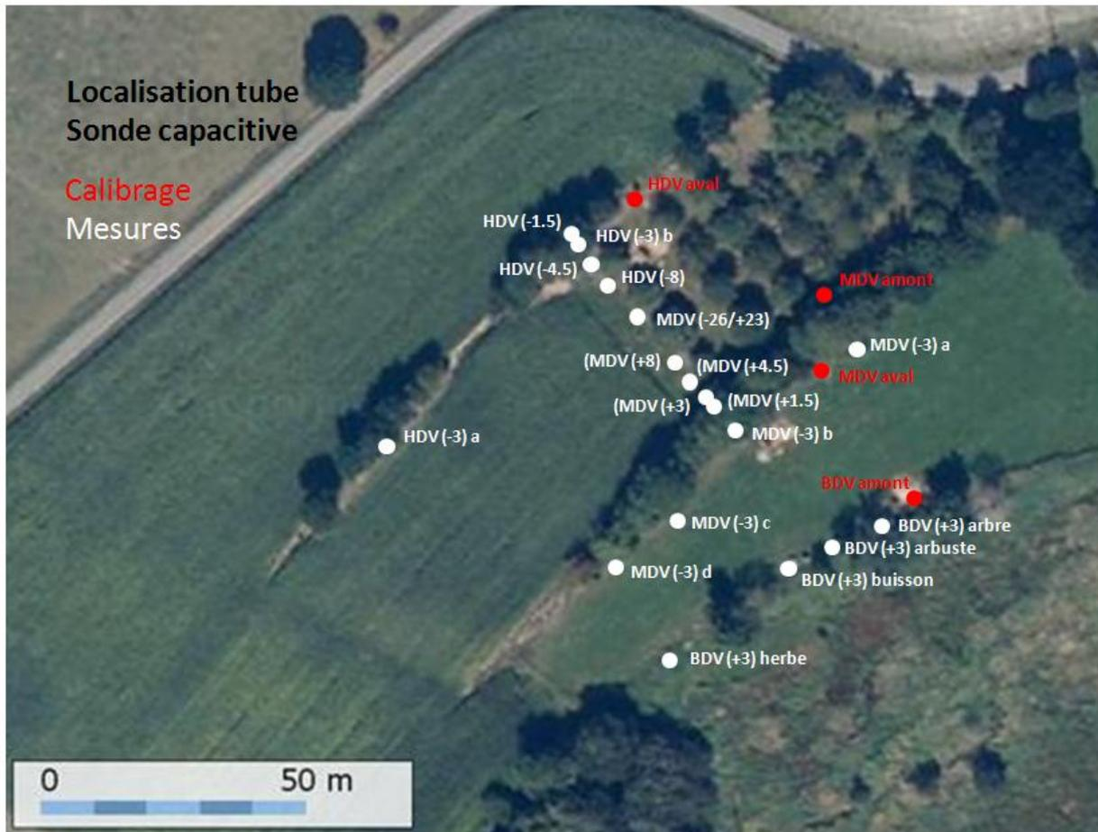
Figure 2.13 – Localisation des tubes pour la sonde capacitive pour les mesures (en blanc) et pour la calibration (en rouge). Les distances à la haie sont entre parenthèse, elles sont positives pour à l’amont et négatives à l’aval. Les lettres distinguent des positions différentes par rapport à l’axe de la haie.
