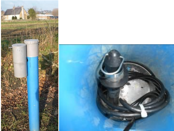
Figure 2.7 – Photographie d'un piézomètre et de son capteur « STS »
