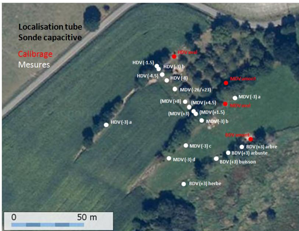
Figure 2.13 – Localisation des tubes pour la sonde capacitive pour les mesures (en blanc) et pour la calibration (en rouge). Les distances à la haie sont entre parenthèse, elles sont positives pour à l’amont et négatives à l’aval. Les lettres distinguent des positions différentes par rapport à l’axe de la haie.
