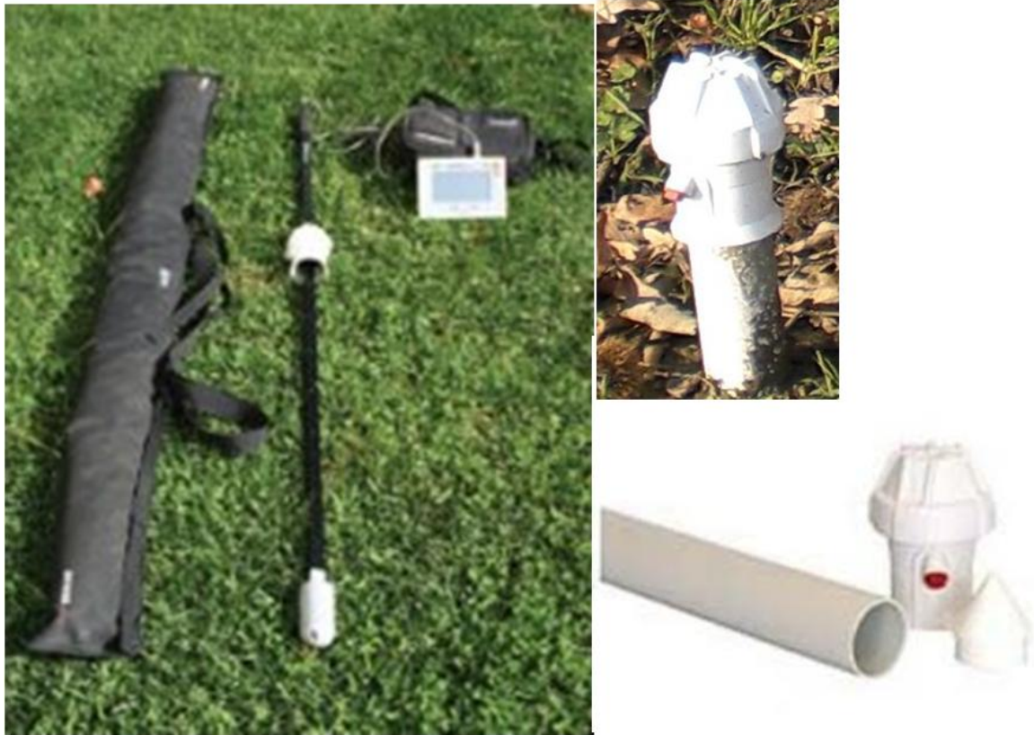
Figure 2.12 – Photo de la sonde capacitive et du tube pvc de mesure placé dans le sol.
