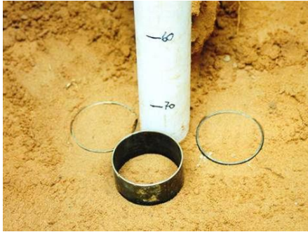
Figure 2.18 – Prélèvement des échantillons autour d'un des tubes tests à l'aide de cylindres de volume connu.
