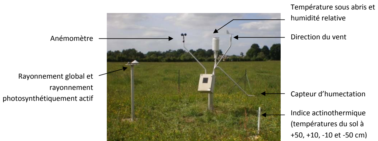
Figure 2.9. Photo de la station de mesure météorologique, dite « Le Toullou ». Les pluviomètres à augets et manuel ne figurent pas sur cette photo.
