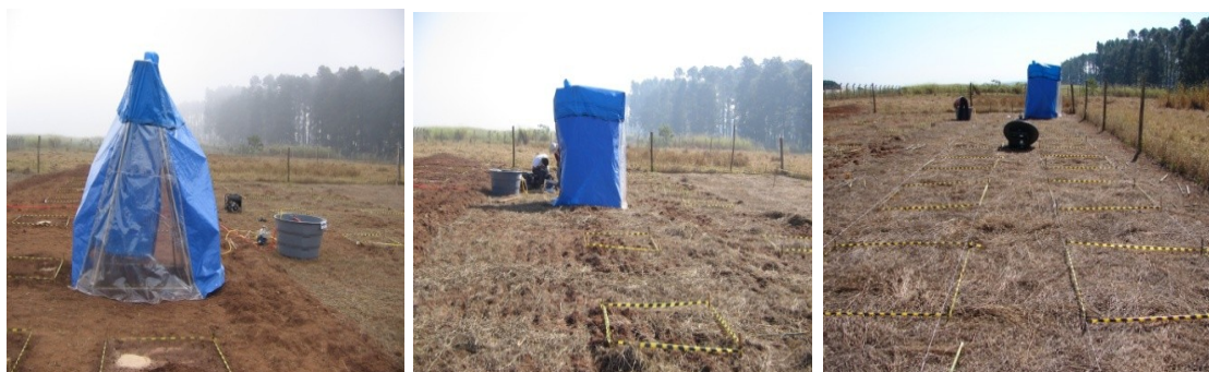
Detalhe da simulação de chuva nos diferentes preparos do solo
