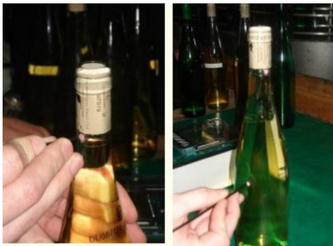
Figure 31 : Lecture de teneurs en oxygène gazeux et dissous dans le vin.
