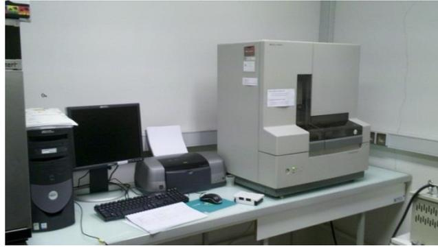
Figure I-13 : Séquenceur capillaire SSCP ABI Prism 3130 genetic analyser
