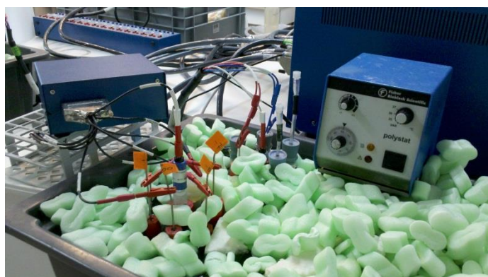
Figure I-4 : Branchement des électrodes dans un réacteur en configuration N-Stat dans un bain-marie.
